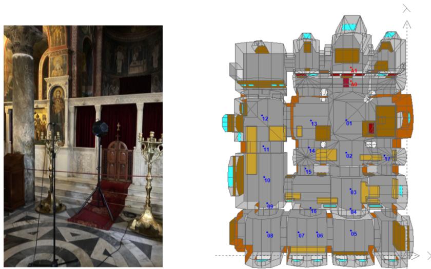
Εικόνα 2.2 αριστερά) Ηχομετρήσεις στο εσωτερικό του Ναού δεξιά) Κάτοψη του Ναού όπου φαίνονται οι 2 θέσεις ηχητικής διέγερσης (A0 και A1) και οι 17 θέσεις ηχομέτρησης
