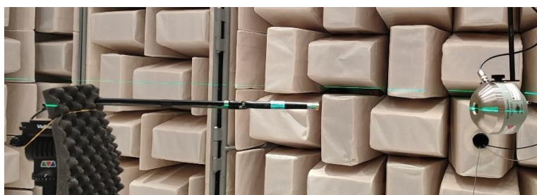
Σχήμα 2.1 Διάταξη διακρίβωσης μικροφώνων εργασίας ελεύθερου πεδίου σε ανηχικό θάλαμο. Αριστερά το μικρόφωνο αναφοράς/εργασίας τοποθετημένο σε ράβδο διαμέτρου 1/2" μήκους 50 cm στερεωμένη σε τρίποδο. Δεξιά η ηχητική πηγή (εξ. διάμετρος 88 mm, οπής 20 mm) B&K 4227 αναρτημένη σε σαρματόσχοινο.
