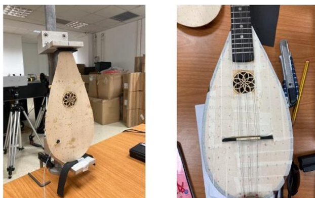
Εικόνα 1.3 Βάση στήριξης για καπάκι με καμάρια (αριστερά) και για τζουρά (δεξιά)
